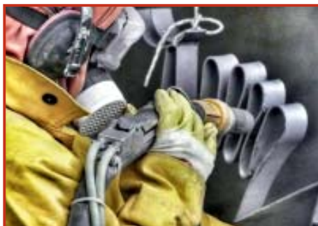
z.B.: Entfernung mehrerer Lackschichten und Rost von Metall (trocken)
